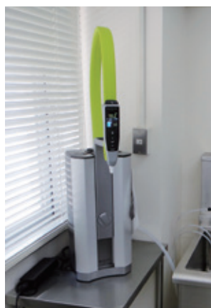
(シンクと並列での設置例) シンクと同じ床 80cm の架台に PURELAB flex 3
