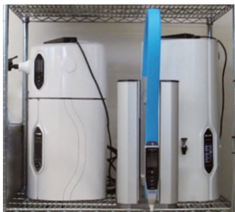
(システムラック中段での設置例) 後方に PURELAB Chorus 2+ (左) と 30L タンク (右) 前方に PURELAB flex UV (採水部低位置固定)
